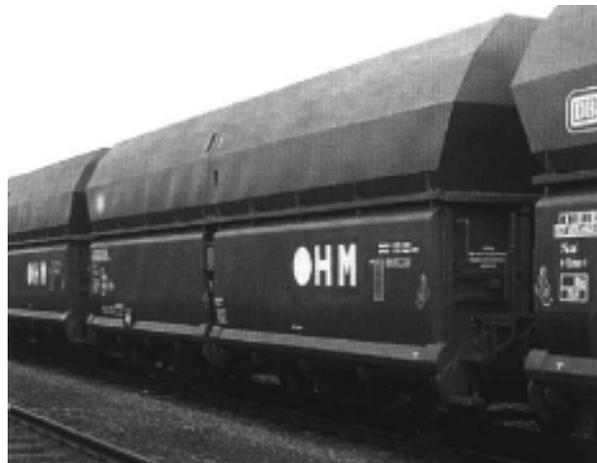
Länge des Zuges: 600 Meter. Nutzlast: 4000 Tonnen. Gesamtgewicht: 5.400 Tonnen. Diese Zugriesen pendeln zwischen Seehäfen und Produktionsstätten. Ihre Ladung: gegen Nässe unempfindliche Schüttgüter, wie zum Beispiel Erze. 1950 wurden nur 28% des benötigten Erzes importiert, heute sind es über 90% - vorwiegend aus Skandinavien.
